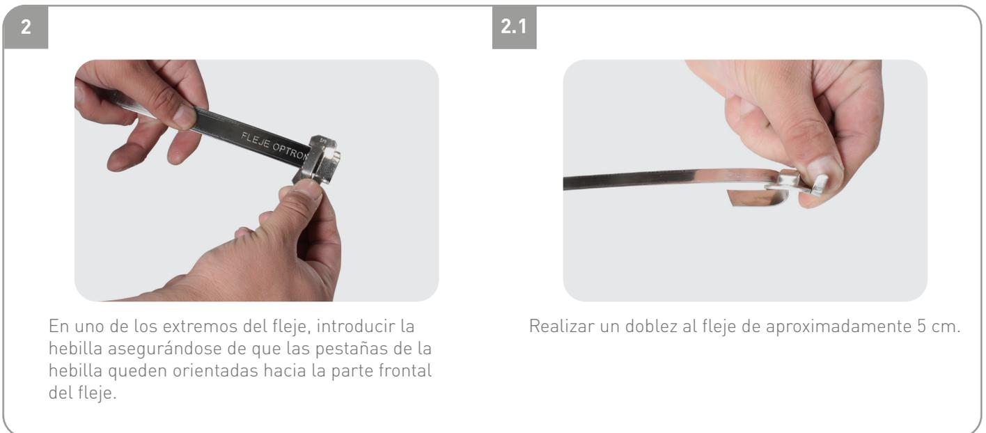
En uno de los extremos del fleje, introducir la hebilla asegurándose de que las pestañas de la hebilla queden orientadas hacia la parte frontal del fleje.
