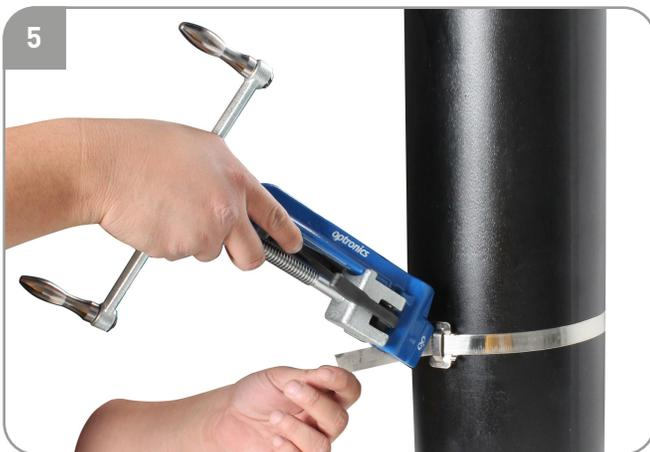
Introducir el fleje previamente doblado sobre el soporte de ajuste de la flejadora.
