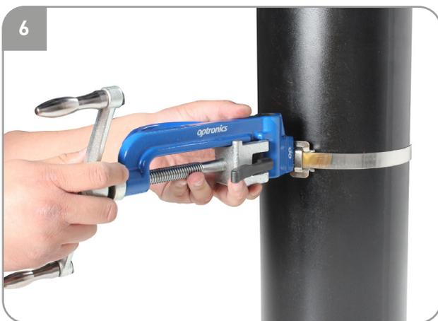
Después de insertar adecuadamente el extremo del fleje en la flejadora, girar la manivela hasta que esté completamente tensionado, asegurándose de que el fleje no tenga ningún movimiento en el poste.
