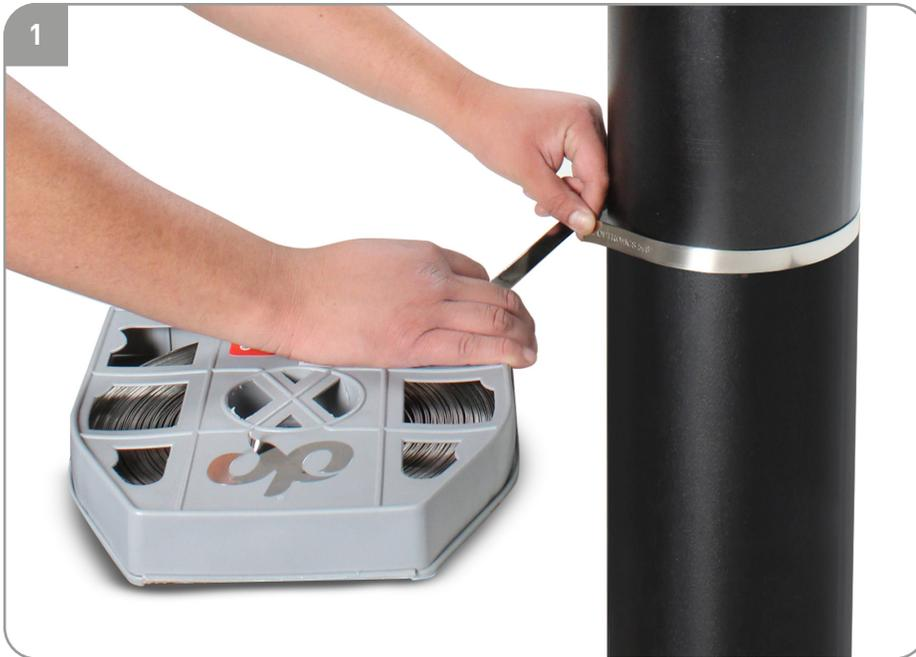
Tomar la medida del diámetro del poste en el lugar de instalación, y cortar el fleje dejando un excedente de 20 cm en relación con el diámetro del poste.
